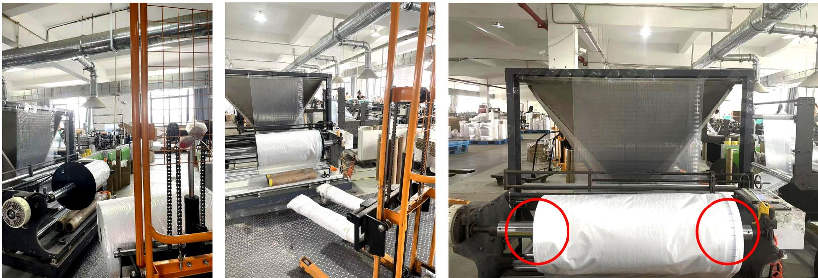
放料：把从A组机器生产线下来的半成品，运至对应的B组机器。放置方式和A组机器放料方式一致。需要注意气阀的左右方位，不能倒置（见上图红色圈标注）。
